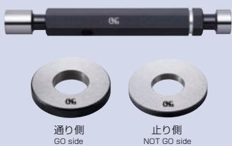
限界プレーンゲージは、穴又は軸の寸法検査に用いるゲージで、一般にプラグゲージ・リングゲージ・挟みゲージが多く用いられます。プラグゲージは通常呼び1mmから120mmまでの穴に用います。呼び1mmから50mmまでは、通り側、止り側が、ハンドルの両端につく両頭形の形状となっています。呼び50mmを超えるものは、通り側、止り側が別々になっている単頭形の形となっており、止り側には識別みぞが設けてあります。ご指定により空気抜き穴を設けます。
