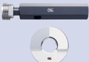
アメリカ規格 (ANSI) による管用テーパねじゲージで、船舶、自動車、航空機などの燃料や油配管の結合に使用され、シール材を使用しないドライシールで、耐密性を保つようになっています。ゲージを使用したとき、L1-プラグとL1-リングで、おねじ・めねじの手締めの長さ (L1) を検査し、L3-プラグとL2-リングで、おねじ・めねじのレンチ締めの長さ (L3とL2-L1) を検査します。そして、2つのゲージL1-プラグとL3-プラグ又はL1-リングとL2-リングの切欠きの関係位置を1/2回転以下にすることにより、製品のテープ度の保証をします。
