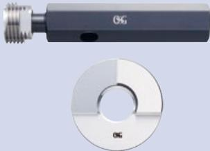
アメリカ規格 (ANSI) による管用テーパねじゲージで、船舶、自動車、航空機などの燃料や油配管の結合に使用され、シール材を使用しないドライシールで、耐密性を保つようになっています。ゲージを使用したとき、L1-プラグとL1-リングで、おねじ・めねじの手締め長さ (L1) を検査し、L3-プラグとL2-リングで、おねじ・めねじのレンチ締め長さ (L3とL2-L1) を検査します。そして、2つのゲージL1-プラグとL3-プラグ又はL1-リングとL2-リングの切欠きの関係位置を1/2回転以下にすることにより、製品のテーパ度の保証をします。
