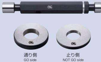
限界プレーンゲージは、穴又は軸の寸法検査に用いるゲージで、一般にプラグゲージ・リングゲージ・挟みゲージが多く用いられます。プラグゲージは通常呼び1mmから120mmまでの穴に用います。呼び1mmから50mmまでは、通り側、止り側が、ハンドルの両端につく両頭形の形状となっています。呼び50mmを超えるものは、通り側、止り側が別々になっている単頭形の形となっており、止り側には識別みぞが設けてあります。ご指定により空気抜き穴を設けます。
