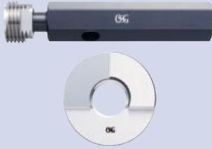
アメリカ規格 (ANSI) による管用テーパねじゲージで、耐密性の必要な一般部品の管用テーパねじ (NPT) の検査に使用します。NPTゲージには切欠きのあるもの、ないものなどいろいろなゲージ規格がありますが、ねじプラグゲージ、ねじリングゲージとも3段切欠き付のタイプ (L1) が一般的です。3段切欠きの使い方は、検査するテーパねじが基準寸法であるとき、おねじとめねじの管端がゲージ中央の切欠け (BASIC) の位置に静止するように設けてあり、他の2つの切欠きは、許容寸法の最大および最小を示しています。
