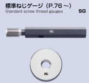
標準ねじゲージはねじの基準山形および基準寸法に正しく作られたゲージで、互いに無理なく遊びなくはめ合うねじプラグゲージとねじリングゲージを組とし、時にはリングゲージの内径に嵌合するめねじ下穴用栓ゲージが附属することがあります。標準ねじゲージは比較測定におけるマスターゲージとして使用する他、直接おねじやめねじにはめ合わせて検査する事もできます。一般には通りねじゲージの役割をさせ「間に合わせ」として用いますが、基準寸法との間にスキマ公域をもつメートルねじ2、3級に相当するものは正確な測定はできません。従ってこのゲージは高精度の少量のねじの検査に適します。
