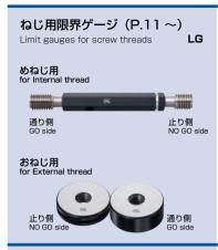
ねじ用限界ゲージは、ねじ規格と同じ等級に定められており、「ねじ」を通り側と止り側の2つの限界方式により検査します。従来のJISゲージ方式ではゲージの止り側には、使用の目的により工作用と検査用がありますが、ISO方式では類別がありません。製品ねじが通り側ゲージを定められたはめあい長さに対し無理なく手でねじ込み、ねじの全長にわたって通り抜け、止り側ゲージを無理なく手でねじ込み、どちらか側からもゲージが2回転(ANSIアメリカ規格では3回転以内)を超えてねじ込まれなければそのねじは検査に合格となります。
