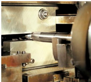
▲セレーションとねじを同時転造作業中
